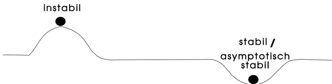
Abb. 9: Stabile, asymptotisch stabile und instabile Zustände
